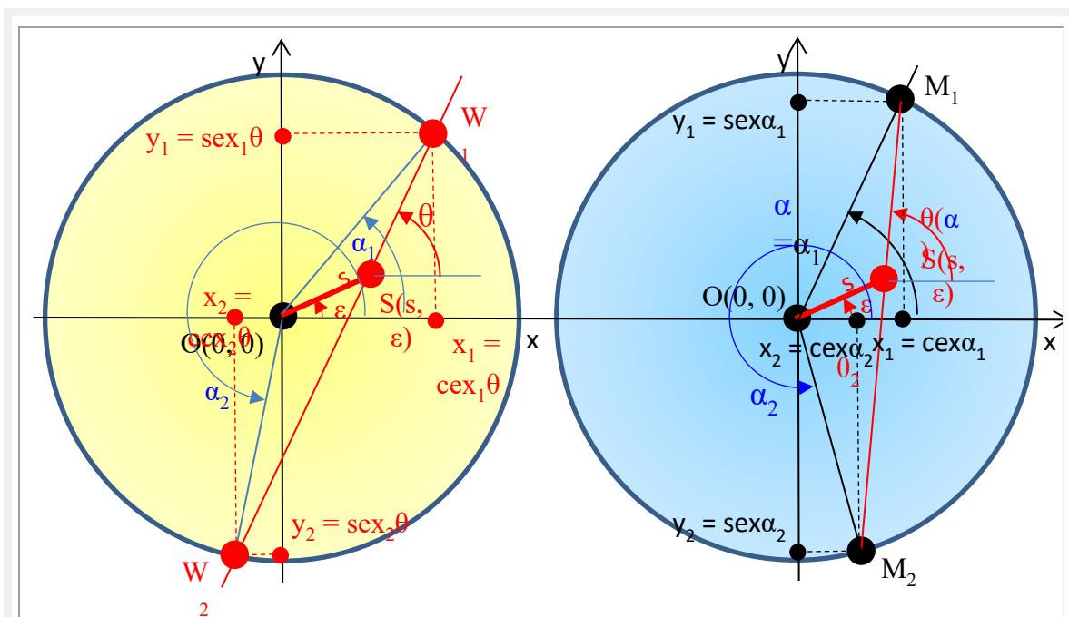
**Fig.1 Schiță explicativă pentru definirea funcțiilor supermatematice circulare excentrice (FSM-CE) cosinus (cex<sub>1,2</sub>θ) și sinus (sex<sub>1,2</sub>θ) de variabilă excentrică θ ◀ și de variabilă centrică α (Cex<sub>1,2</sub> și Sex<sub>1,2</sub>) ►**
