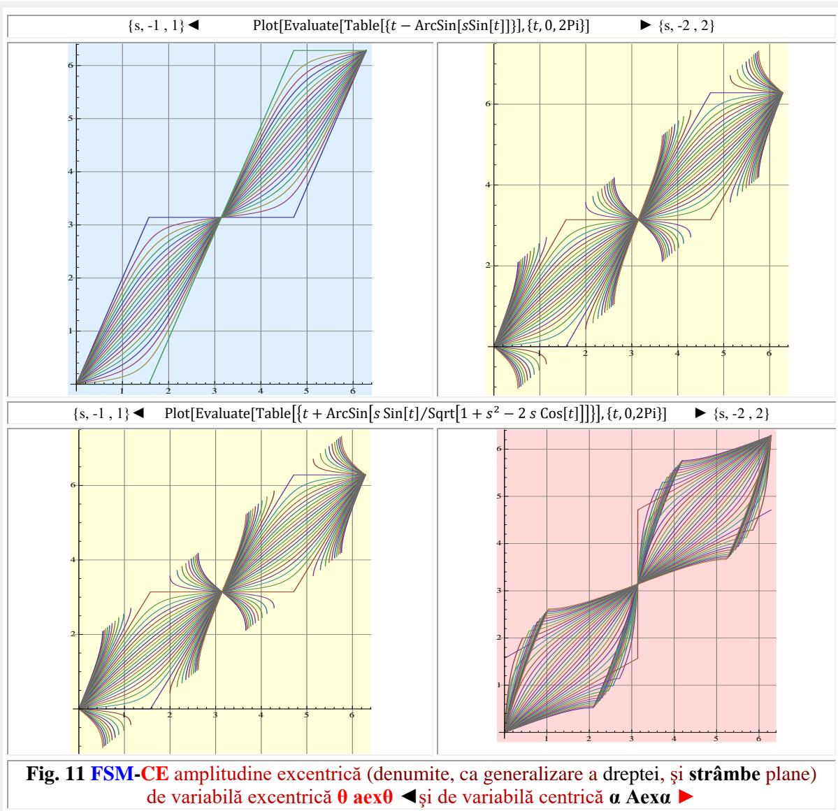
**Fig. 11 FSM-CE amplitudine excentrică (denumite, ca generalizare a dreptei, și strâmbe plane) de variabilă excentrică  $\theta$   $a_{ex\theta}$  ◀ și de variabilă centrică  $a$   $A_{ex\alpha}$  ▶**
